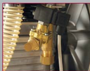
ELETTOVALVOLA Per ridurre la pressione del cilindro nelle fasi di avviamento.
